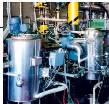
Die Biturox-Pilotanlage ermöglicht es, die optimalen Prozessbedingungen zu ermitteln
