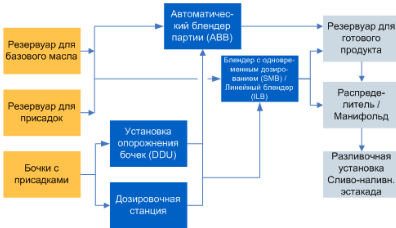
Блок-схема установки блендинга масло-смазочных материалов
