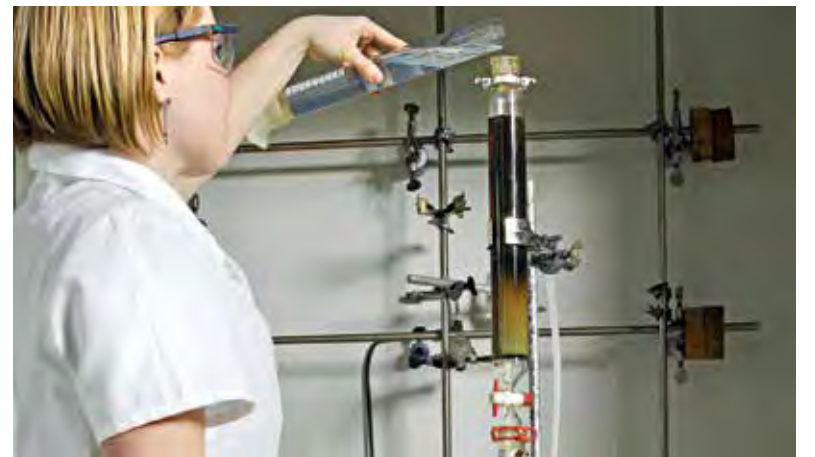
Испытательный стенд для анализа процесса деасфальтизации.
