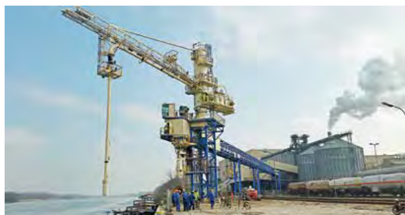
Тридцатиметровый кран, оснащенный стрелой длиной 22 м, позволяет разгружать около 300 т сырья в час, а также отгружать большое количество тонн промышленных продуктов.
