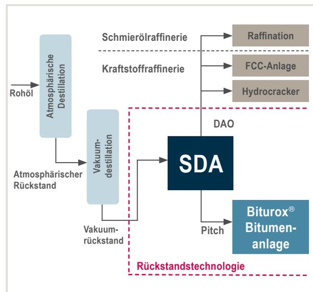
Abb. 2: SDA-Anlage als Bestandteil einer modernen Rückstandstechnologie
