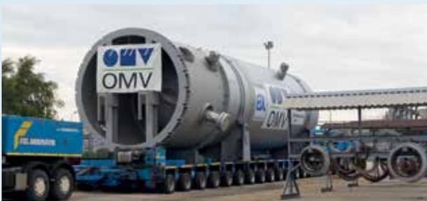
nicht, da der Reaktor unter einer Rohrbrücke mit nur 8 cm Spielraum durchgeschliffen werden musste. Die Aufrichtung des Reaktors erfolgte mit einem speziell angefertigten Montageportalkran. Am 22. April wurde termingerecht die mechanische Fertigstellung der HDS3-Anlage gemeldet, die bereits kurz danach „on spec“ produzierte.
