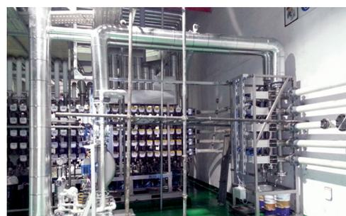
Установка блендинга с блендером с одновременным дозированием (SMB) и манифольдом для автоматического производства смазочных материалов (до 40 партий/сутки), GS Caltex Corporation, г. Сеул / Южная Корея, 2015г.
