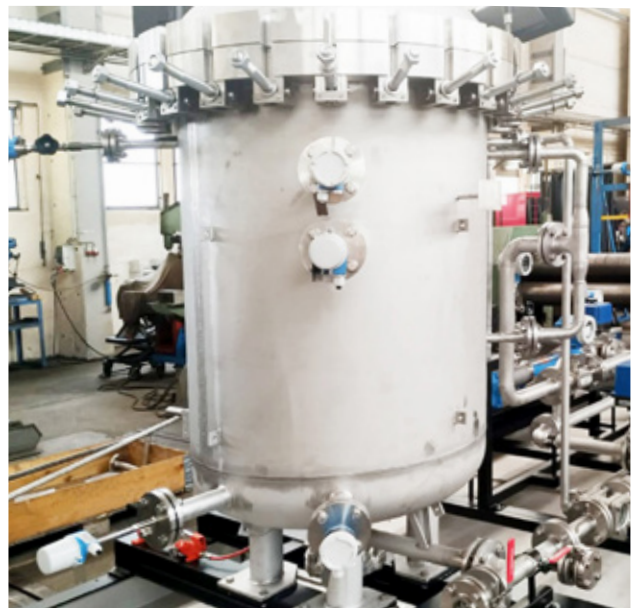
Abb. 1: LEPD-Pilotanlage der EDL in Leipzig, während der Montage
