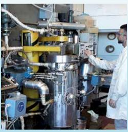
Biturox<sup>®</sup> pilot test unit
