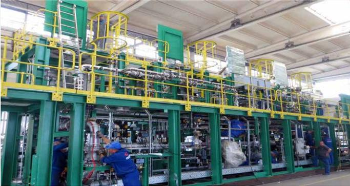
Поставка и ввод в эксплуатацию системы очистки пластовой воды для повторной закачки в нефтяное месторождение производительностью 164 м<sup>3</sup>/ч (1-й этап расширения 1) и 82 м<sup>3</sup>/ч (2-й этап расширения).
