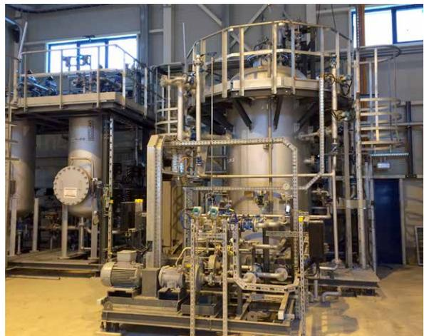
Поставка и ввод в эксплуатацию системы очистки пластовой воды для повторной закачки в нефтяное месторождение производительностью 41,6 м³/ч (6 300 баррелей в сутки); (Тазлау / Румыния, реализация компанией Siemens)
