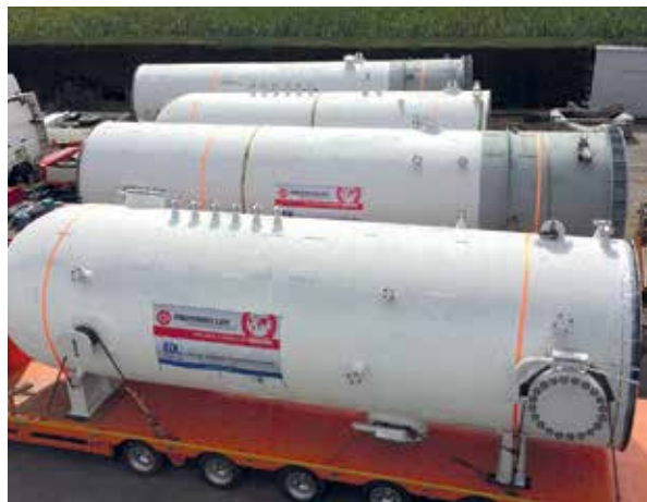
Рис. 4: ОАО «Нафтан», Новополоцк, Беларусь: проектирование и поставка двух экстракционных колонн для реконструкции установки деасфальтизации гудрона пропаном
