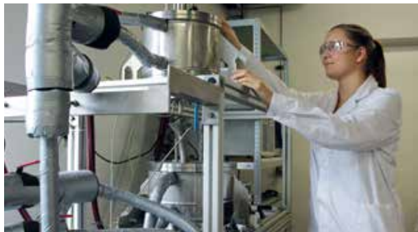
Пилотная установка депарафинизации / обезмасливания в Лейпциге
