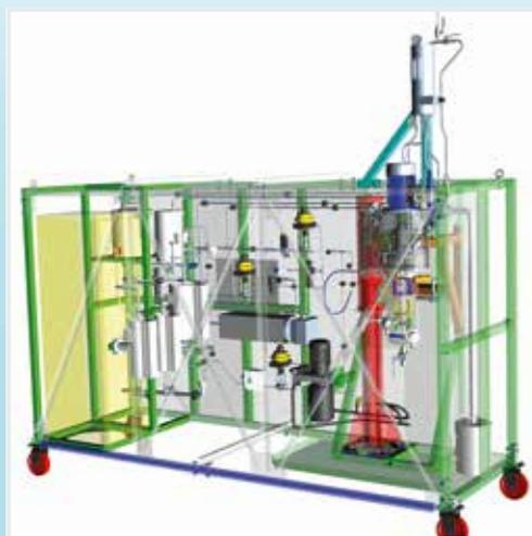
Трехмерная модель пилотной установки Biturox®
